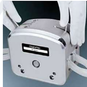
3. Instale el bloque superior y baje las palancas para cerrar el bloque.
